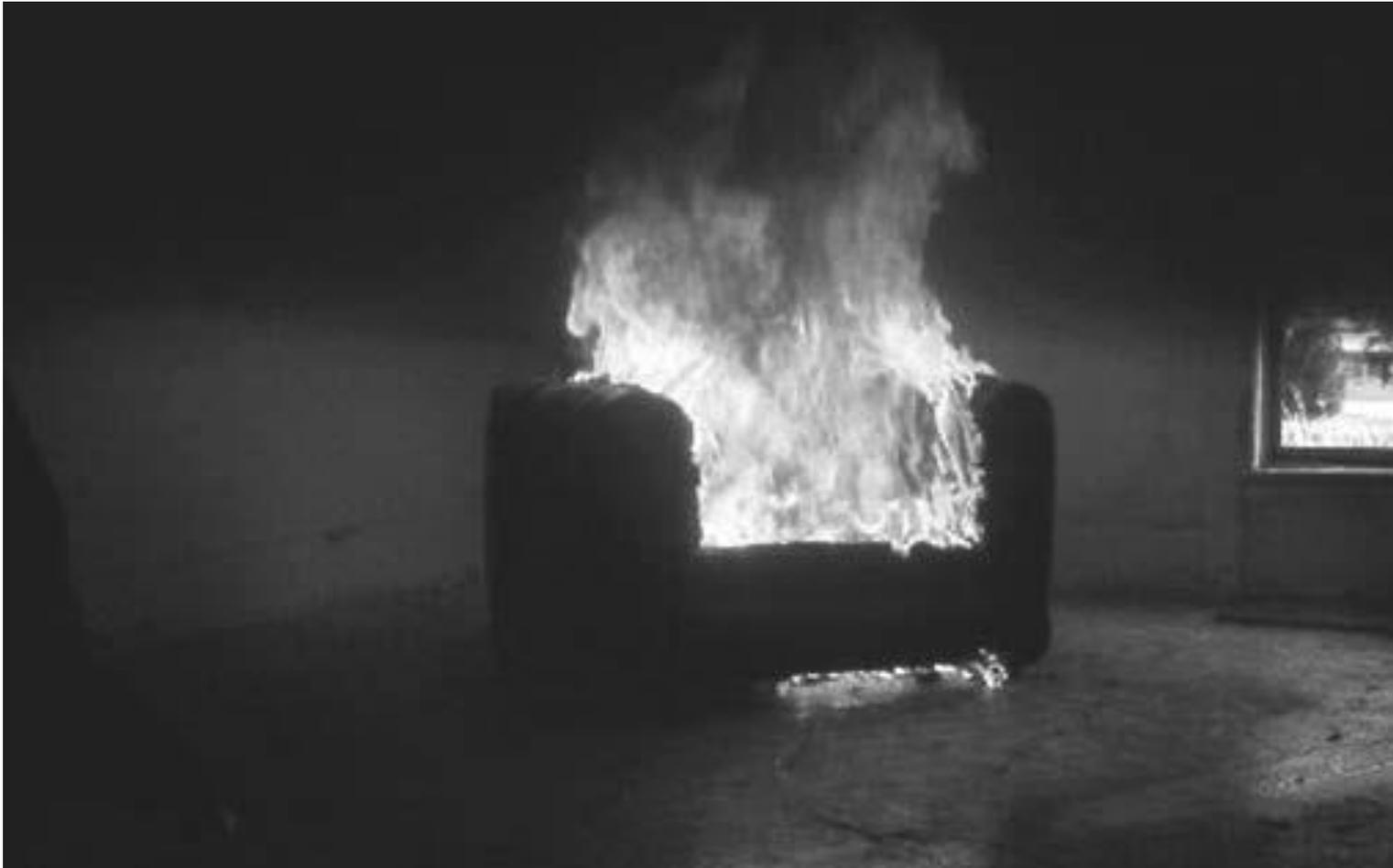
FIGURA 6.3.7.8.6(b) Ensayo de Combustión No Acelerada que Demuestra la Fusión, Goteo, Formación de Charco y Combustión Del Relleno de una Silla Tapizada
