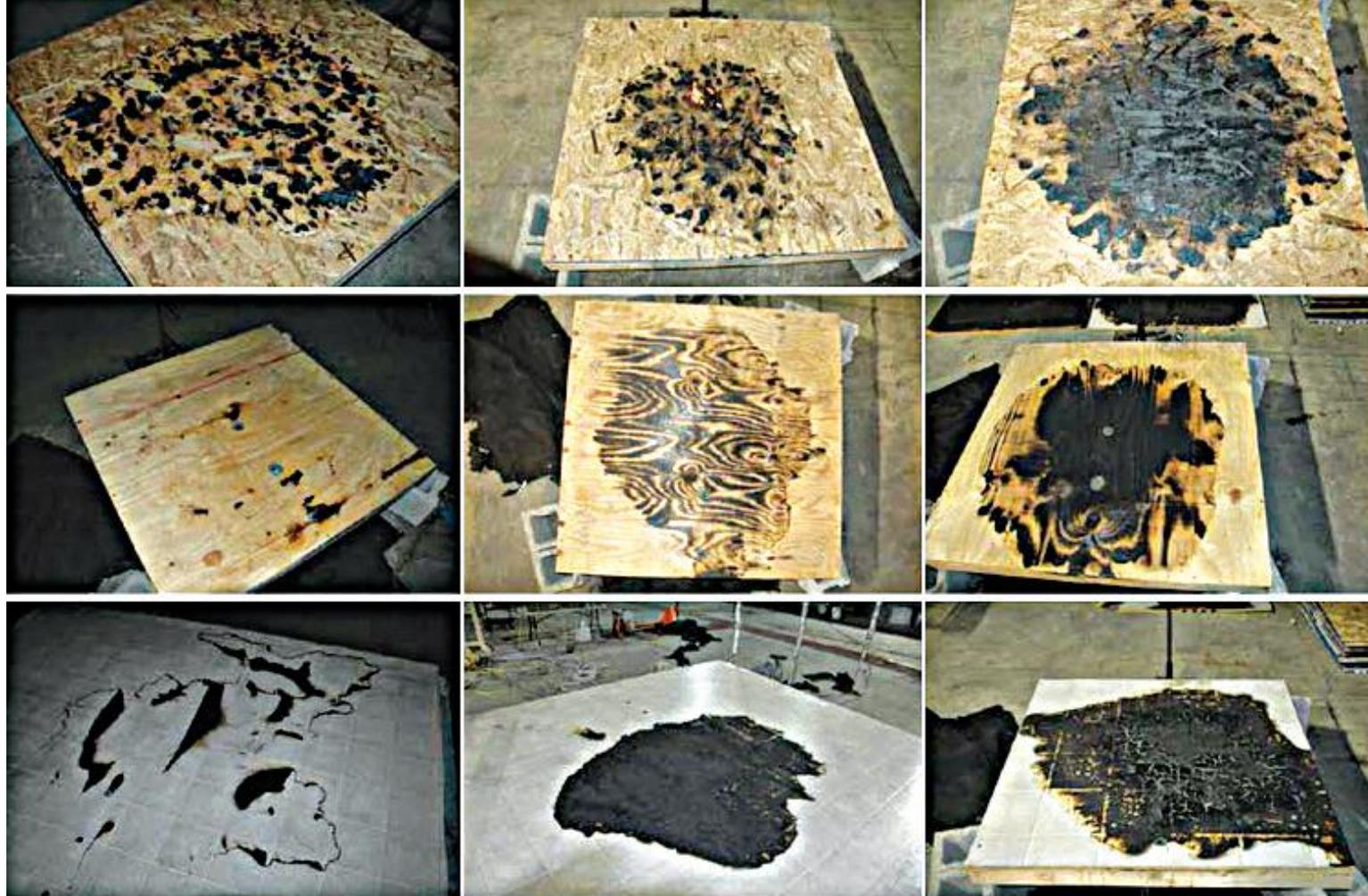
FIGURA 6.3.7.8.4(a) Comparación entre las marcas producidas al verter 0.5 L de tres combustibles distintos, sobre tres sustratos diferentes. Los combustibles incluyen alcohol de quemar (izquierda), gasolina (centro), y queroseno (derecha). Los sustratos fueron tableros OSB (tablero de virutas orientadas) (parte superior), contrachapado (centro), y vinilo (parte inferior)
